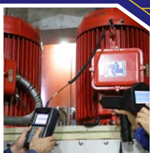
انجام تست‌های پایش وضعیت (CM) شامل: ارتعاش سنجی، صوت سنجی، ترموگرافی و آنالیز روغن تجهیزات نیروگاه‌های برق آبی کشور
