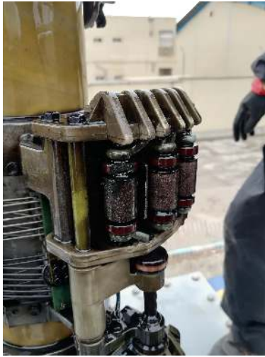
شکل ۳- وضعیت ناسالم کنتاکتها
