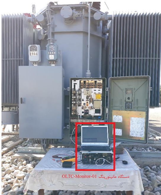
شکل ۶- دستگاه مانیتورینگ تپ‌چنجر OLTC-Monitor-01 در حین انجام یک تست برخط.
