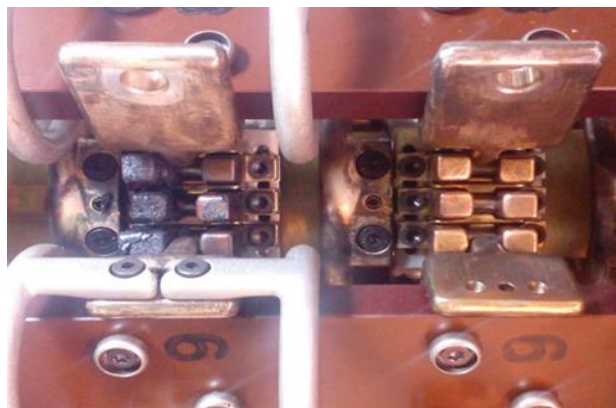
شکل ۶: محل سولفاته شدن کنتاکت های تپ چنجر
