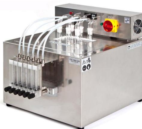
شکل ۲- نمونه ای از دستگاه انجام تست پایداری اکسیداسیون
