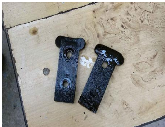
شکل ۵: کنتاکت کربونیزه شده و داراب رسوب بسیار شدید در تپ سلکتور
