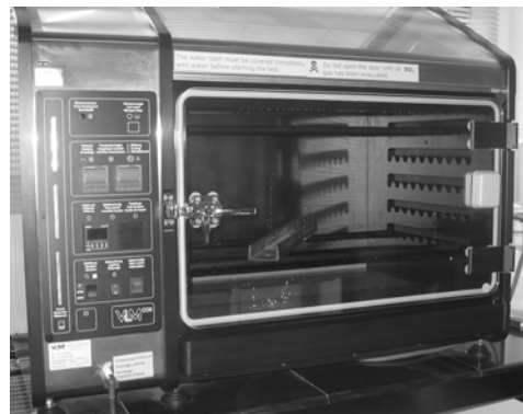
شکل ۱- محفظه آزمون خوردگی دی اکسید گوگرد در اتمسفر مرطوب اشباع مطابق استاندارد ASTM
