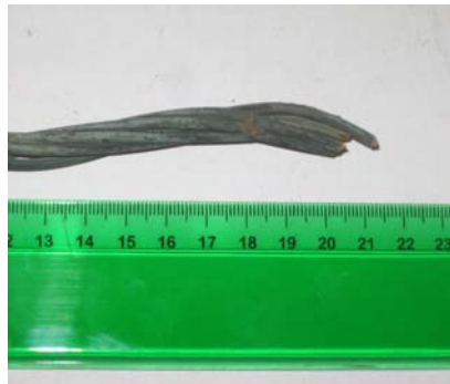
شکل ۲- نمای ظاهری هادی مسی استفاده شده در مناطق نفتخیز گچساران
