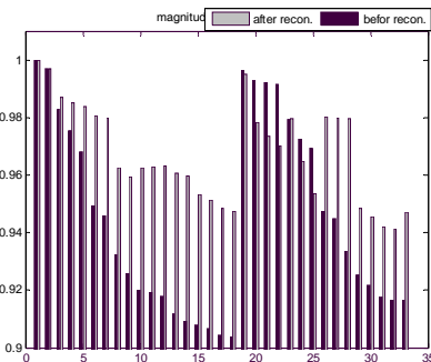
شکل ۸: مقایسه پروفیل ولتاژ قبل و بعد از بازآرایی با الگوریتم وراثتی باینری جهت تابع F2
