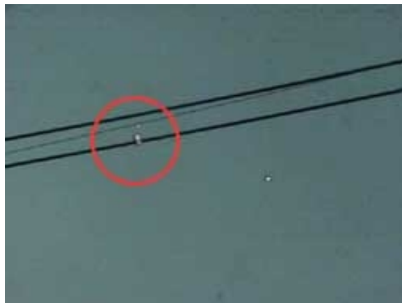
مشاهده کرونا در نمونه بی خطر از یک خط شبکه
