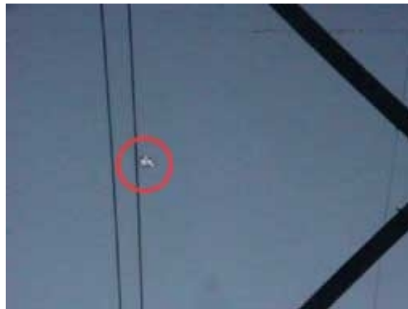
مشاهده کرونا در نمونه بی خطر از یک خط شبکه
