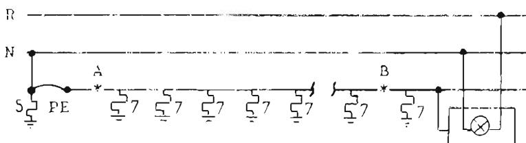
چنانچه سیم پنجم در نقطه A یا B قطع شود مطابق حالت ۱ بوده و قطعی در A در پست اصلی و قطعی در B در روی پایه ها خطر آفرین است.
