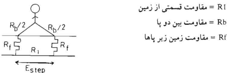
برای جلوگیری از اثرات نامطلوب ولتاژ قدم می‌توان مقاومت زمین را در اطراف پایه افزایش داد. این کار را می‌توان با استفاده از یک لایه بتن یا سنگریزه در زیر پایه به انجام رسانید. در این حالت باید چاه اتصال زمین کمی دور تراز پایه حفر شود تا امکان بازدید و همچنین تماس با رطوبت زمین برای آن فراهم باشد. البته استفاده از شبکهٔ فلزی برای هم پتانسیل کردن محدوده نزدیک پایه متصور است لیکن هزینه آن نسبتاً زیاد است.
