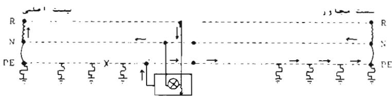
مدار معادل این اتصال بدن به شکل زیر است.
